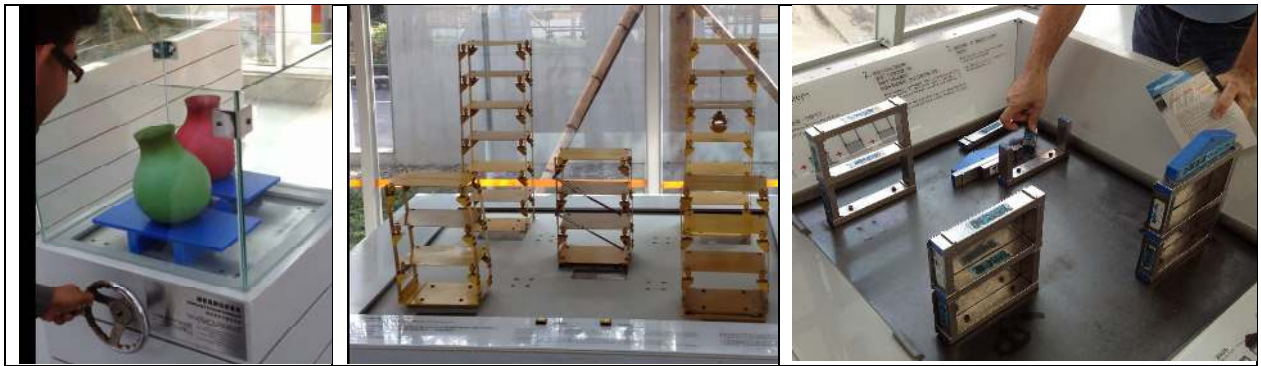
Şekil 7. Farklı yapı tiplerinin deprem altındaki davranışlarının basit deneyleri
